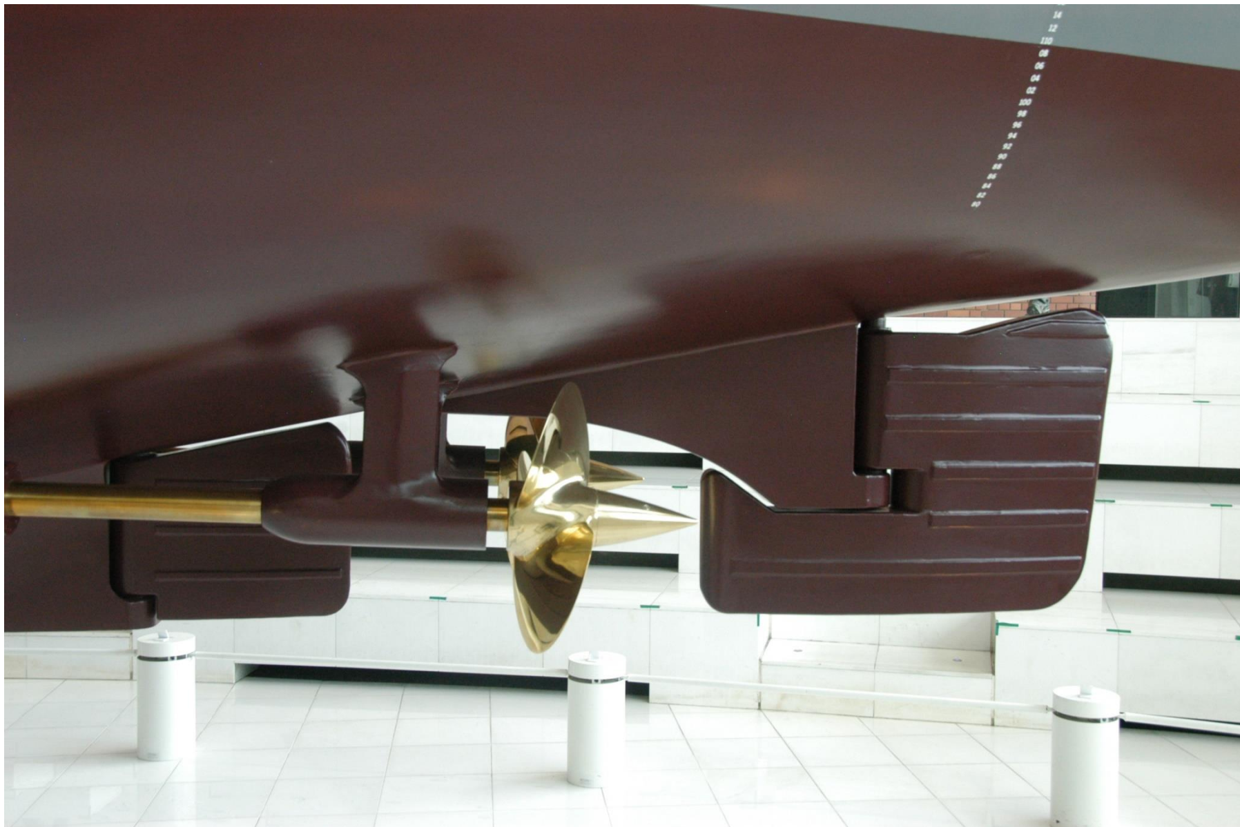
Yamatos roder. Det lilla till vänster är ett nödroder. När jag provkörde min modell med skalariktigt roder var vändradien markant sämre än originalets (i skala).
