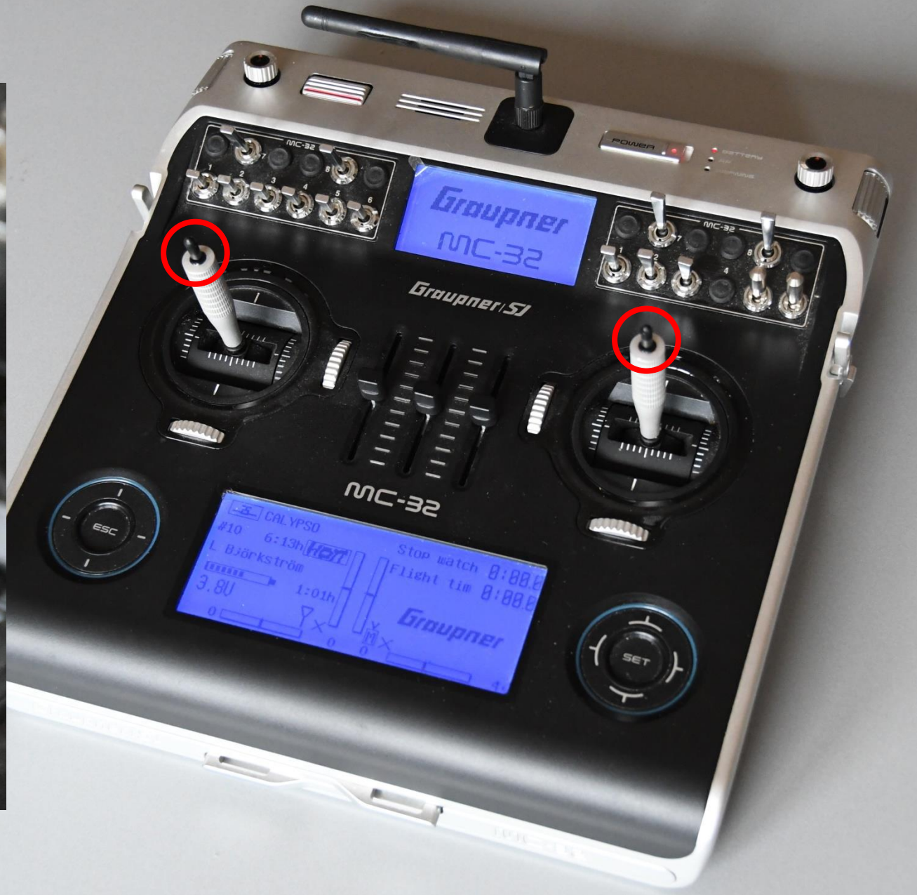
Mixerfunktioner som är olika för körning framåt respektive bakåt manövreras med fördel med 3-lägesbrytare i spaktopparna. Lätt att kolla läget utan att ta ögonen från modellen.
